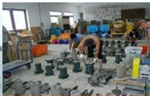
(2) 應用新材料澆灌混凝土試體
