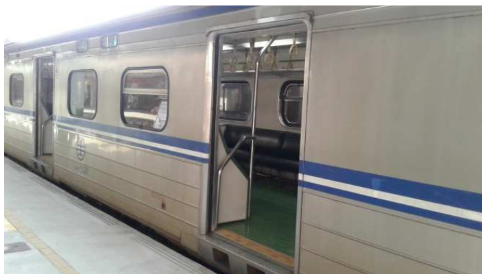
無階化施作後 出入口齊平
