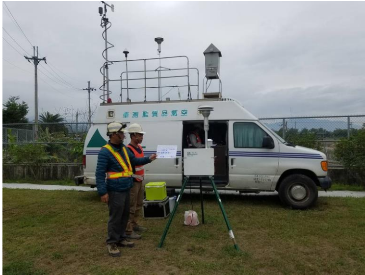
第 M37C2 標 施工前空氣品質監測
