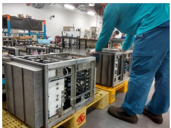
輔電模組檢修
