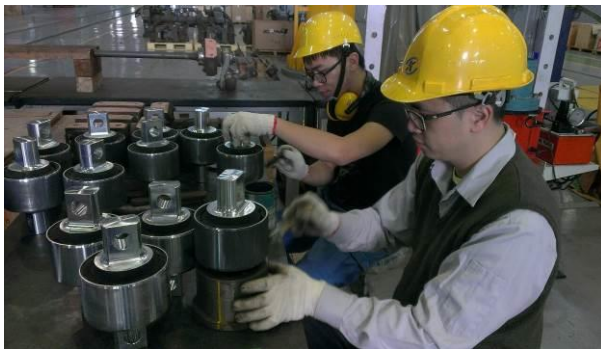
牽引桿軸襯更換
