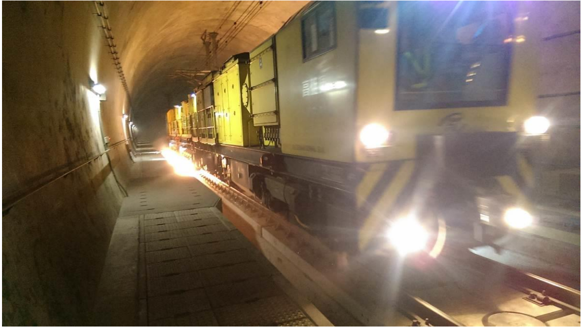
高鐵南港延伸線上研磨作業
