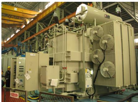
主變電站變壓器工廠測試(1)
