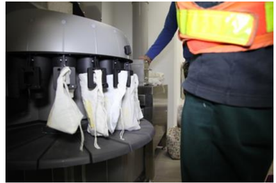
自動收費設備系統點幣機功能測試
