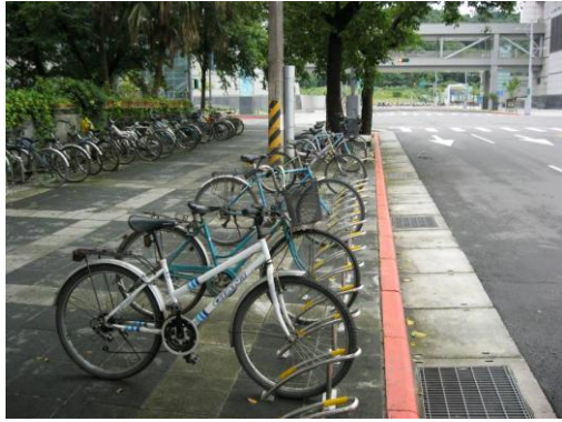
圖 8 前輪置放式自行車架 (鎖前輪，適用於人行道設施帶較寬地點，可規範停車秩序較為整齊)
