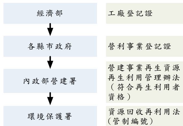
圖 3.4 公告後之申請流程圖-以瀝青混凝土挖(刨)除料為例
