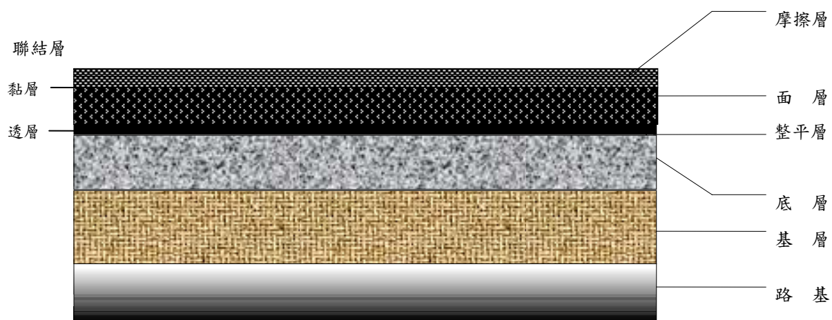
圖 6.1 柔性鋪面結構示意圖
