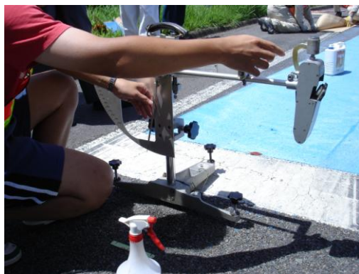
圖 3.2.41 傳統道路抗滑值量測試
