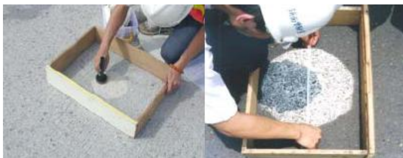
圖 3.5.7 將固定體積之鋪成圓面及量測其直徑
