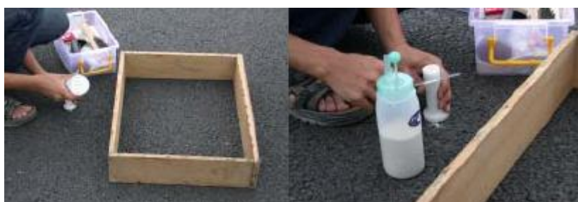
圖 3.5.6 選定測點及放置標準砂
