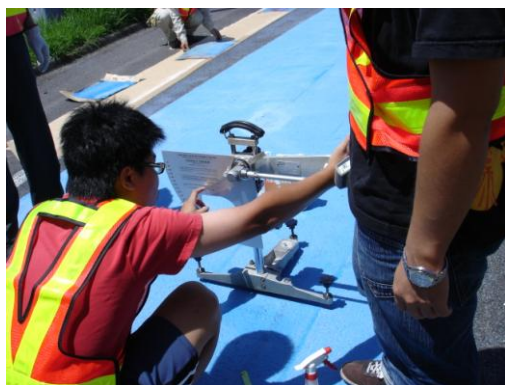
圖 3.2.42 彩色塗裝道路抗滑值量測試
