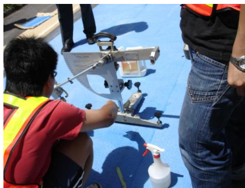
圖 3.2.42 彩色塗裝道路抗滑值量測試
