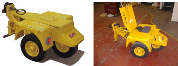
圖 3.5.10 Mu-Meter 抗滑儀
