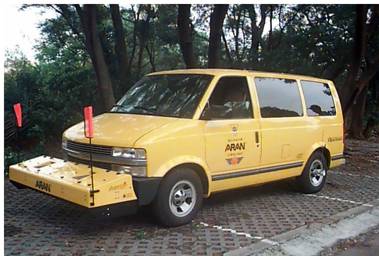
圖 3.5.3 ARAN 智慧型鋪面檢測車
