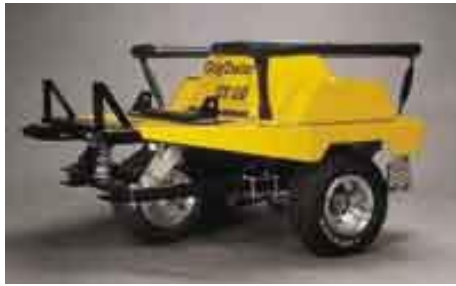
圖 3.5.9 GripTester 抗滑儀器
