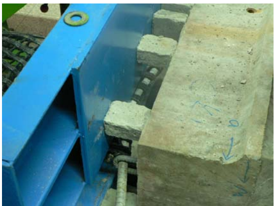
圖 7-12 面版連結構件拉力試驗
