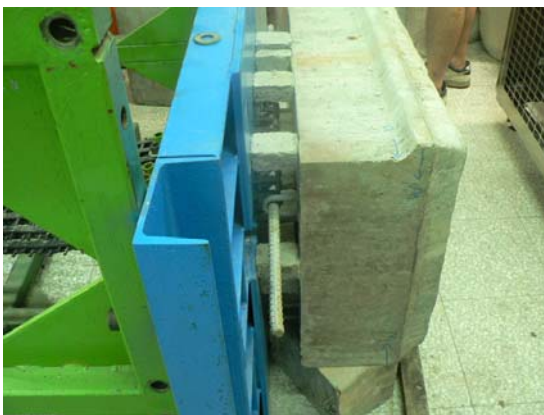
圖 7-12 面版連結構件拉力試驗
