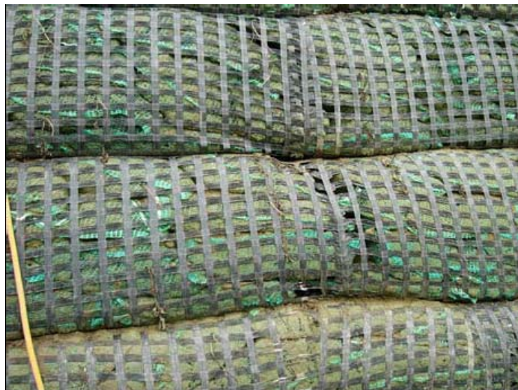
圖 2-10 加勁材料橫向斷裂
