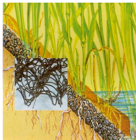
圖 4-7(a)表面植生綠化示意圖 4-7(b)表面植生綠化剖面圖
