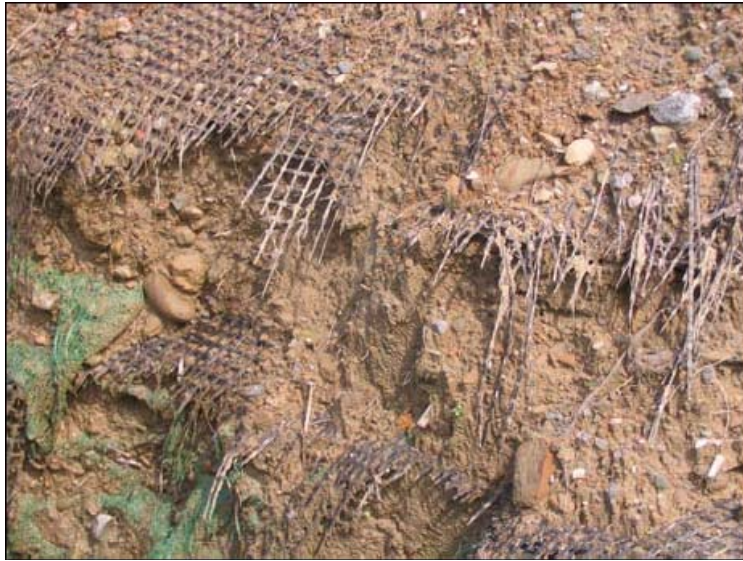
圖 2-9 加勁材料縱向斷裂
