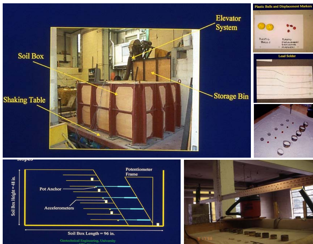
圖 5-5 全尺寸振動台試驗與配置示意圖
