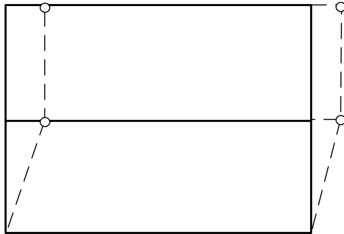
(b)可接受之型態—4 個塑性鉸(非液化狀況)
