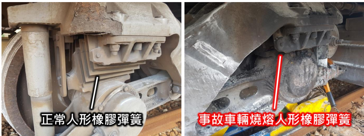
圖 3.2.2-1 正常及燒熔之人形橡膠彈簧
