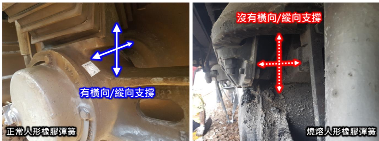
圖 3.4-1 人型橡膠彈簧燒熔缺乏支撐
