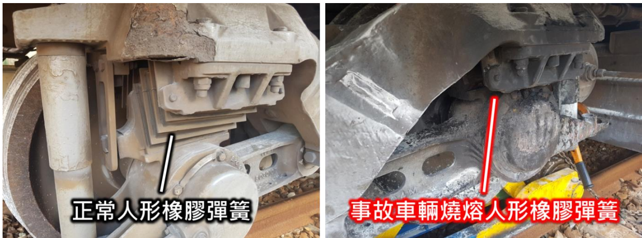
圖 3.2.3-4 正常及燒熔之人型橡膠彈簧
