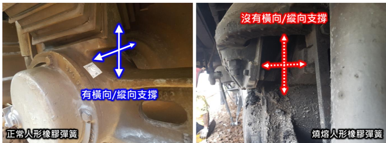
圖 3.2.3-5 人型橡膠彈簧燒熔缺乏支撐
