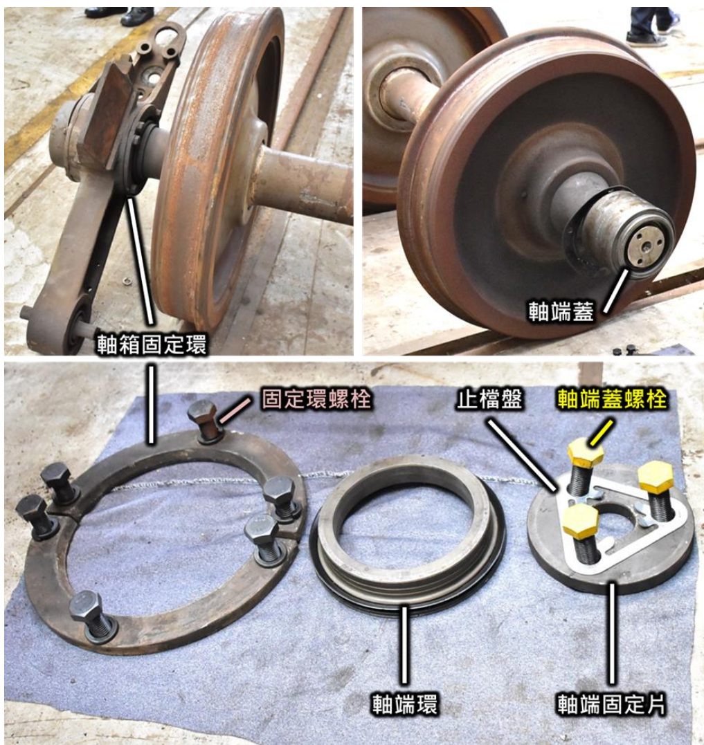
圖 3.2.3-2 軸端及軸箱相關零組件
