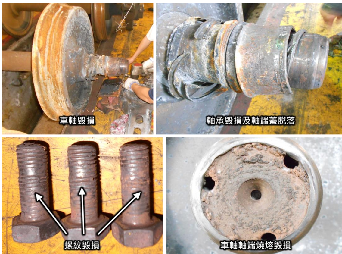
圖 3.2.3-1 ET549 號第 3 軸受損情形
