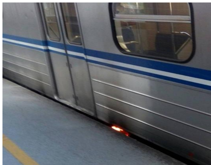
圖 3.4-1 車廂與月台間隙狹小無法滅火
