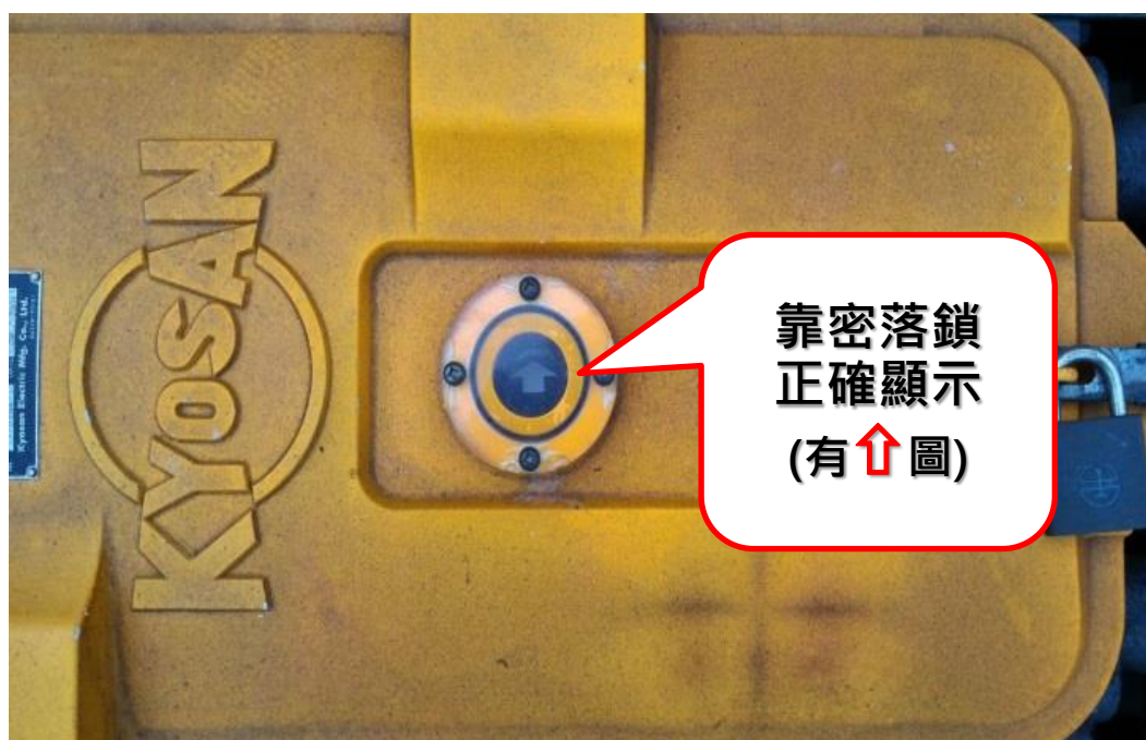
圖 2.1-4 轉轍器靠密落鎖顯示照片
