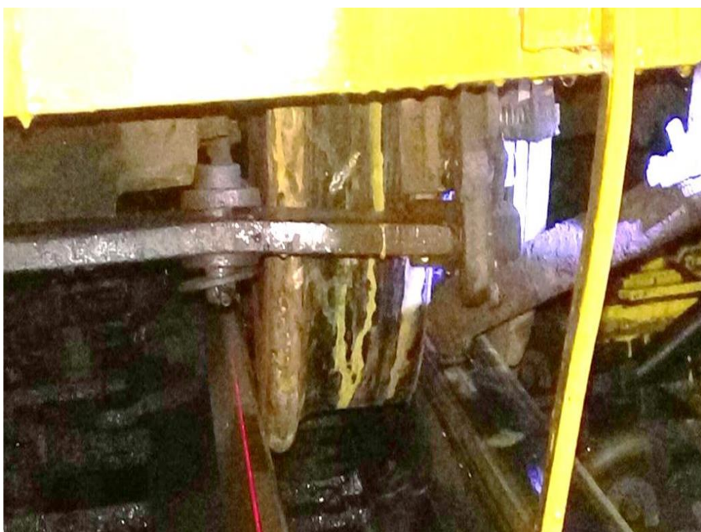
圖 2.1-3 第 802 號電搖車出軌照片
