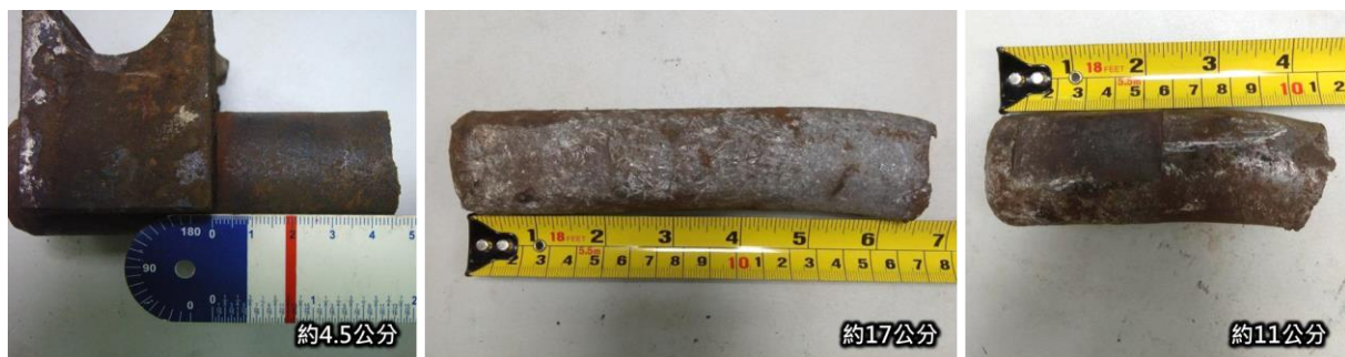
圖 3.2.2-2 斷裂之下搖枕吊銷
