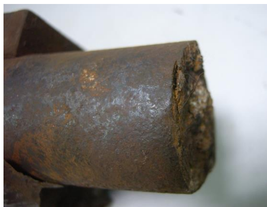
圖 3.2.2-4 下搖枕吊銷斷裂處生鏽
