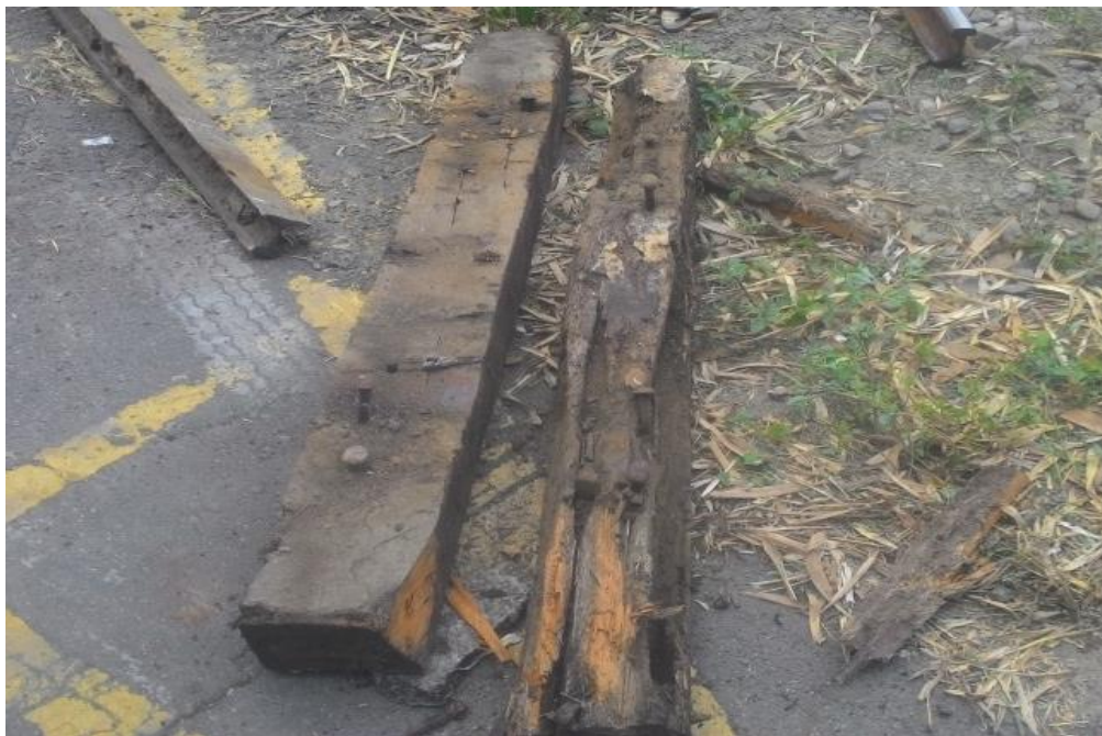
圖 3.2.1-2 AC 鋪面下枕木腐朽情形
