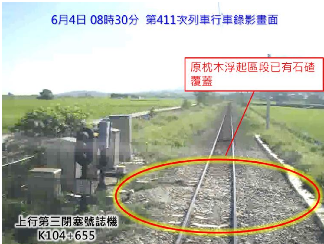
圖 2.4-6 K104+655 處 6 月 4 日鋼軌方向整正後之路線狀況
