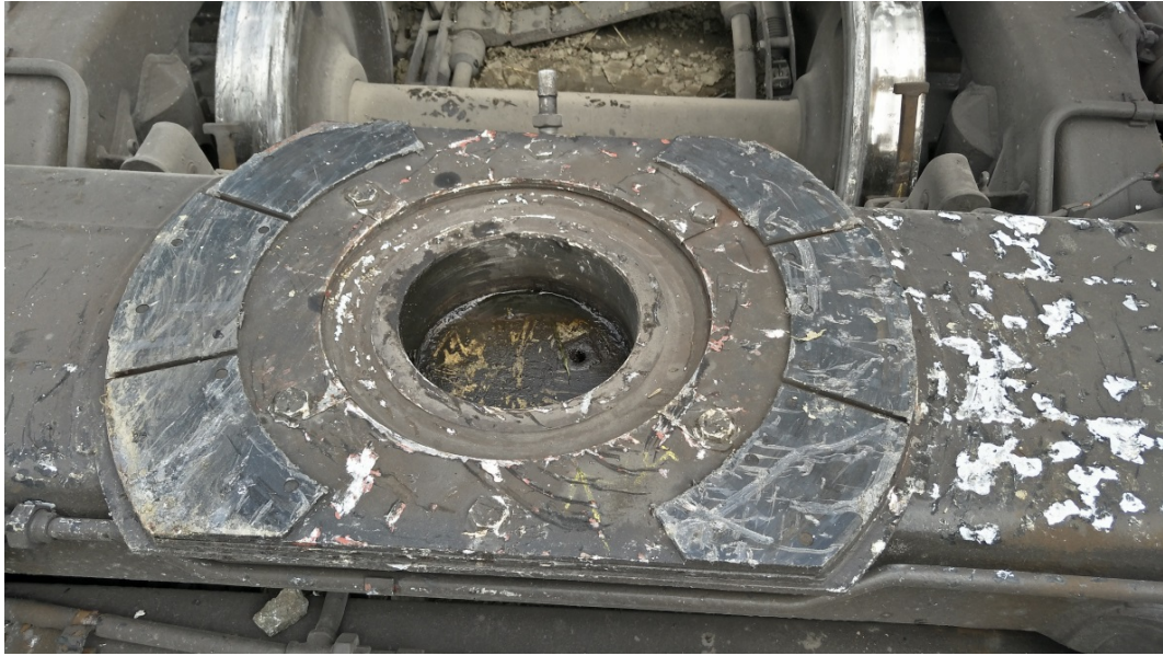
圖 3.4-15 DR3000 型轉向架中心梢支撐點及襯墊
