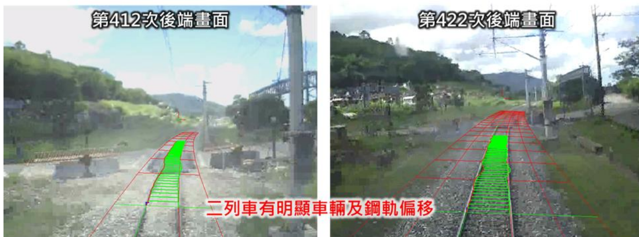
圖 3.4-11 二列車鋼軌偏移情形
