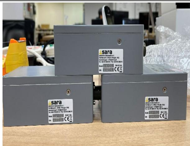
圖 48 單軸向力平衡加速度計
