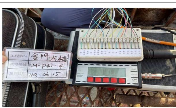
圖 46 鋼筋腐蝕計電壓及電阻量測
