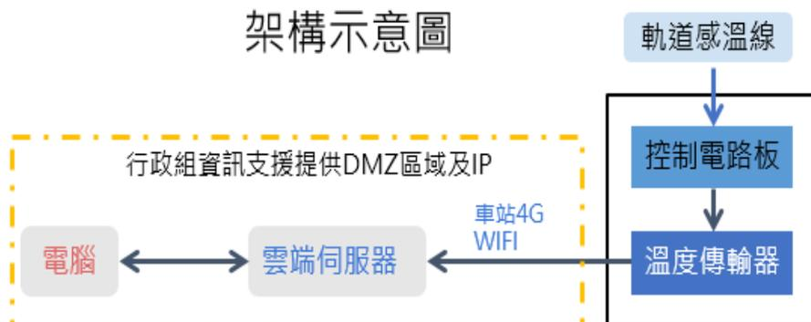
圖 4 軌溫智慧預警監控系統架構示意圖
