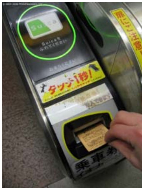
圖 2.18 日本驗票閘門之磁卡插入口
