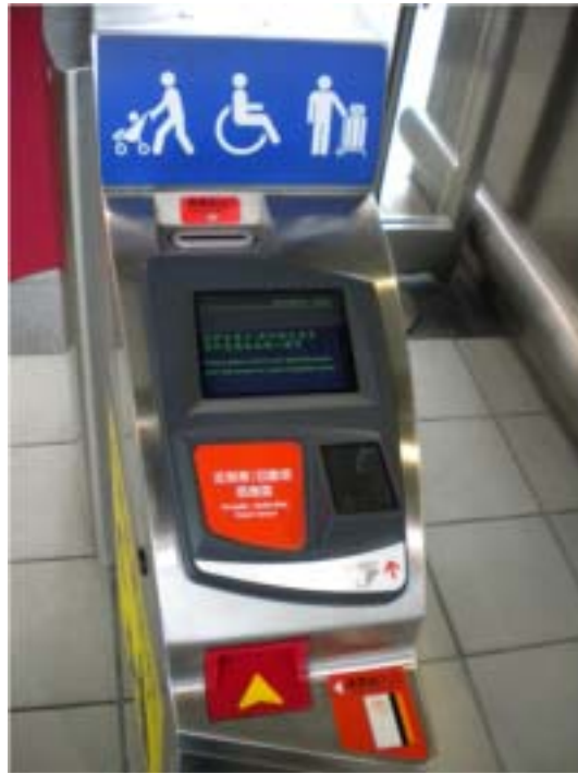
圖 2.11 台灣高鐵自動驗票閘門之驗票模組外觀
