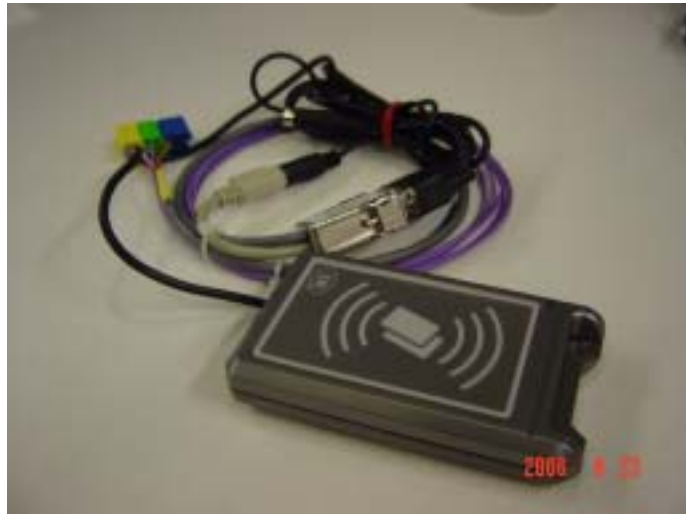
圖 2.2.5 遠傳電信 VPS 車機之 Mifare Card 金融 IC 卡讀取模組
