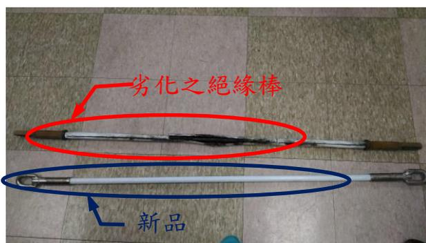
圖 2.4.2-2 107 年 9 月 28 日中壢站內絕緣劣化之絕緣棒與備品比較
