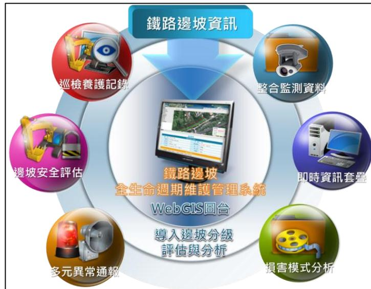
圖 4.2.2-5 鐵路邊坡全生命週期維護管理系統示意圖
