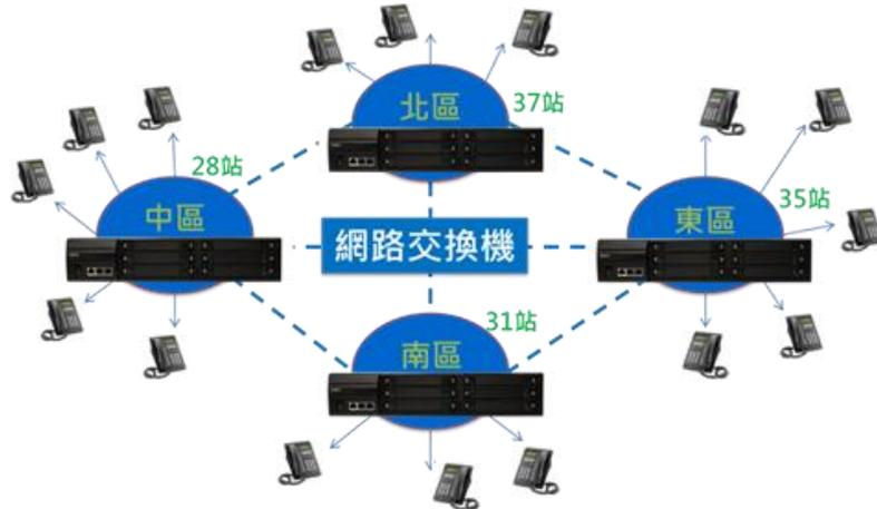
圖 3.2.4-4 有線調度銅纜更新為光纜傳輸示意圖
