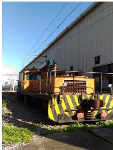
圖 6.3.3-2 臺北電力段電車線維修車
