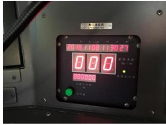
ATP 正常時車速顯示(MMI 操作面盤)
